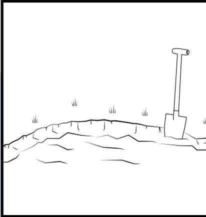
Markieren Sie die gewünschte Form und ebenen Sie den Boden/ Untergrund. Einen Rasenrand stechen Sie mit einem Spaten ab.
