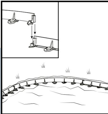
Legen Sie die Rasenkante auf das gewünschte Stück. Schieben Sie die Endstücke ineinander, um die Rasenkanten miteinander zu verbinden. Überstehende Längen können mit einer Handsäge für Holz gekürzt werden.
